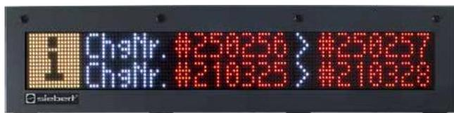
Матрица P4 имеет шаг пикселя 4 мм, матрица P8 имеет шаг пикселя 8 мм. Размеры шрифтов см. на стр. 13.
